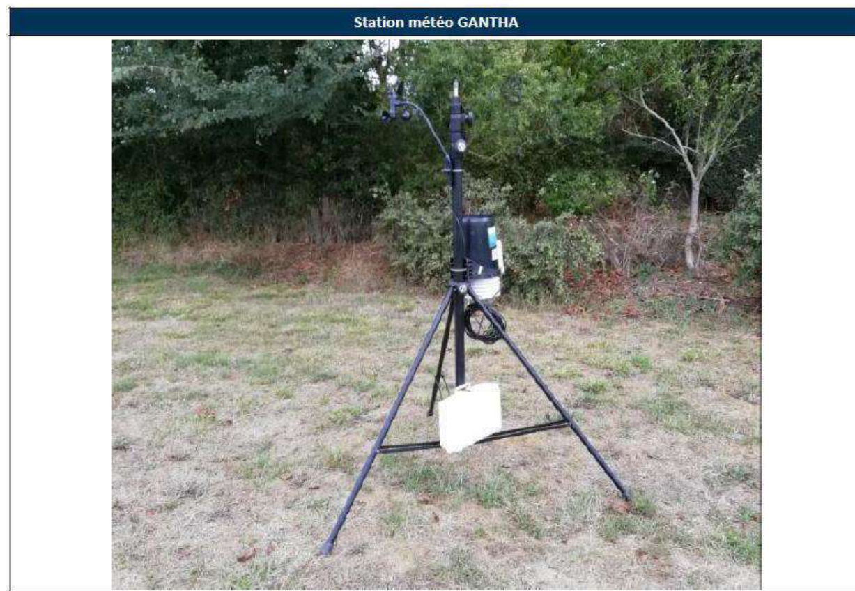
Figure 386 : Station météorologique à 1,5 m au sol
